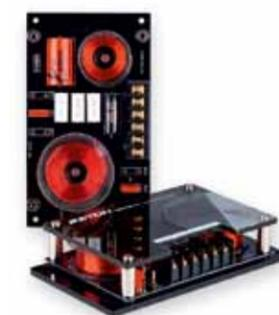
2-Wege High End SQ Frequenzweichen-Set, bestückt mit hochwertigen Bauteilen, speziell abgestimmt für den Einsatz mit den ETON GRAPHIT Systemen, Pegelanpassung des Hochtöners um -2/ 0 +2 dB. Anpassung der Flankensteilheit des Tiefmitteltöners um 6 und 12 dB/Okt., Abmessungen (L x B x H): 163 x 94 x 36 mm, Engineered in Germany.
